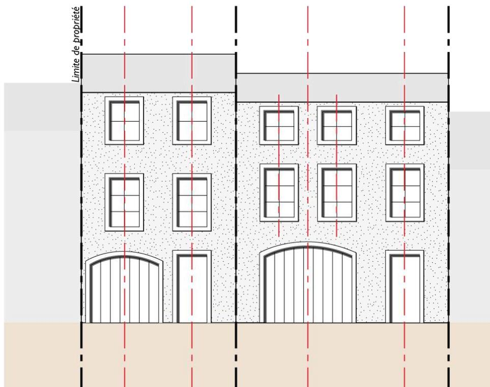
**Schéma explicatif : alignement des axes des ouvertures en façade**
