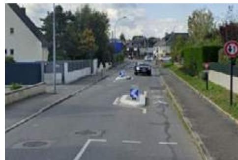
Système d'écluse avec bypass vélo
