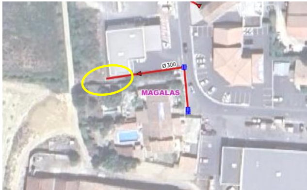
Figure 9 : Exutoire sous terrain privé non recensé
