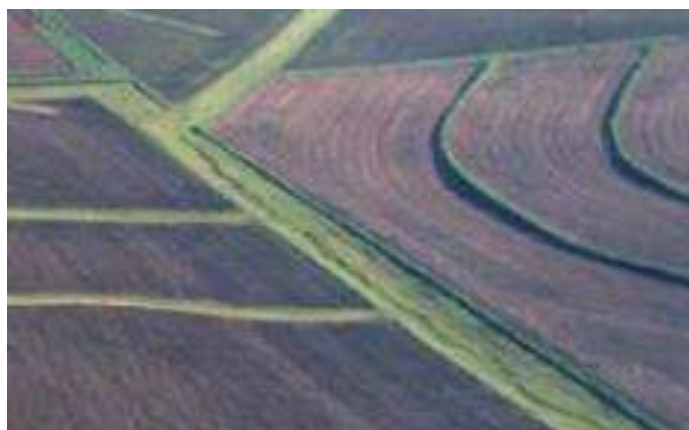
Figure 3-5 : Exemple d'un talweg enherbé
