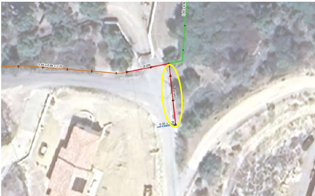
Figure 11 : Localisation de la buse encombrée à 50% Chemin d Puech de Montcal
