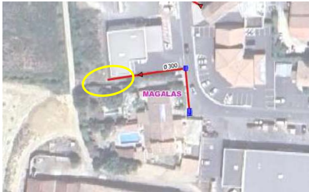
Figure 9 : Exutoire sous terrain privé non recensé
