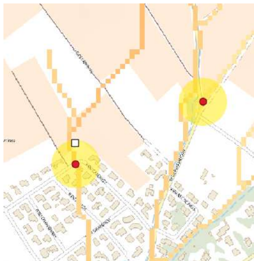
Figure 4-10. Exemple d'association de désordres à des axes d'écoulement théoriques dans un rayon de 50 m sur la commune de Lieuran-lès-Béziers.
