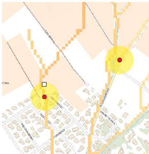
Figure 1-17. Exemple d'association de désordres à des axes d'écoulement théoriques dans un rayon de 50 m sur la commune de Lieuran-lès-Béziers.
