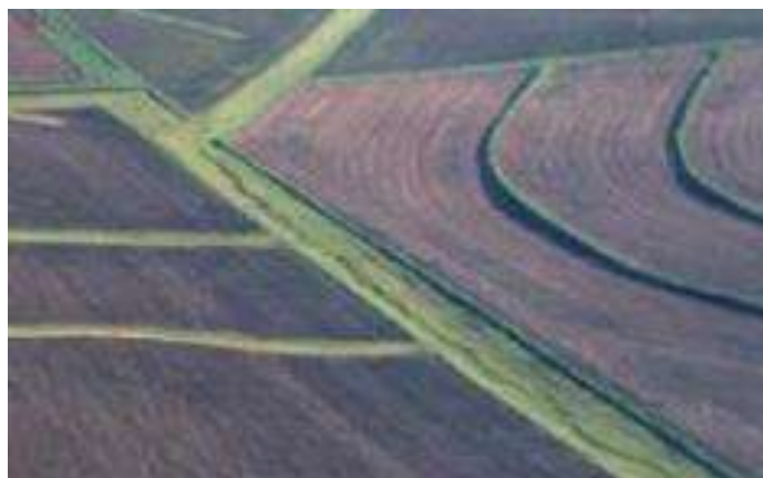
Figure 2-5 : Exemple d'un talweg enherbé
