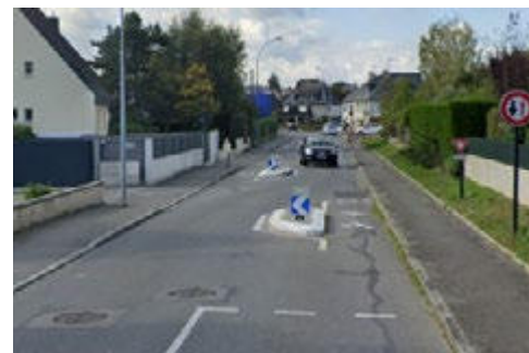
Système d'écluse avec bypass vélo
