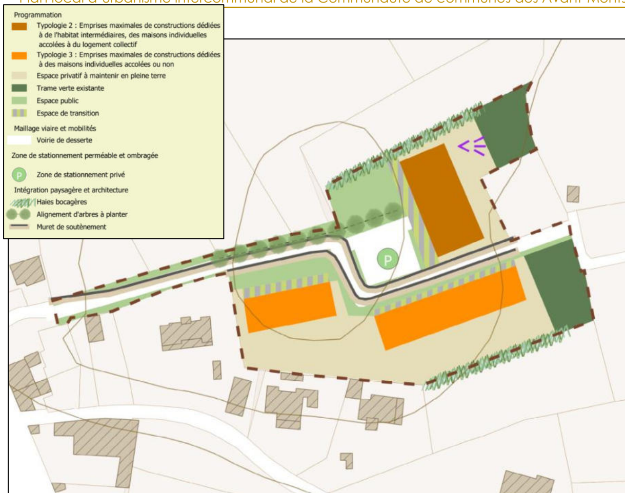
Figure 18. Exemple d'OAP avec prise en compte de la présence d'un muret de soutènement en pierres sèches (schistes) sur la commune de Faugères.
